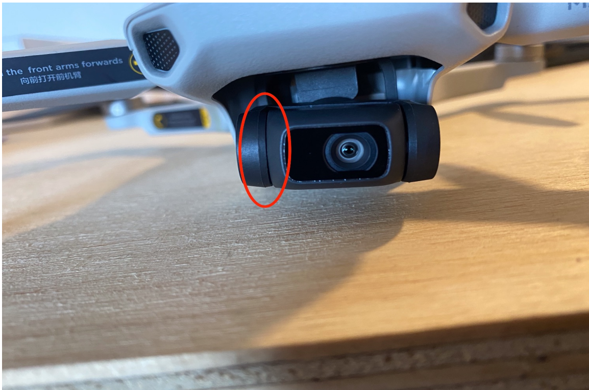
Ảnh: Cát hoặc các vật nhỏ có thể dẫn đến lỗi Gimbal stuck
